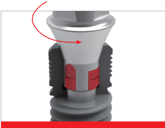
图 3a: 插入基台, 步骤 2 基台不断旋入直至与 4 个种植体沟槽对准。
